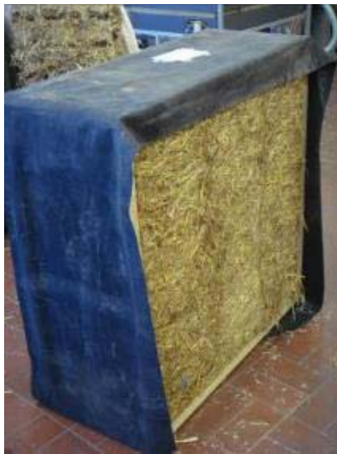
2 Un des échantillons testés, un cadre de 100x100x36 cm.
