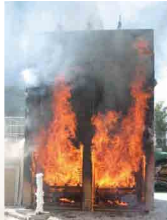
4 Le test de résistance au feu réalisé par le CSTB : les ballots de paille toujours en place dans les montants latéraux de la façade sont uniquement carbonisés en surface à certains endroits. Pour vérifier l'état intérieur des ballots, le CSTB a dû les sectionner. D'autres photos montrent les ballots en place et faiblement carbonisés en surface ; elles sont disponibles sur www.lemoniteur.fr/media/FICHER/2010/02/22/FICHER_2010_02_22_1059781.pdf
