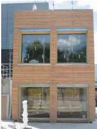
4 Le test de résistance au feu réalisé par le CSTB : les ballots de paille toujours en place dans les montants latéraux de la façade sont uniquement carbonisés en surface à certains endroits. Pour vérifier l'état intérieur des ballots, le CSTB a dû les sectionner. D'autres photos montrent les ballots en place et faiblement carbonisés en surface ; elles sont disponibles sur www.lemoniteur.fr/media/FICHER/2010/02/22/FICHER_2010_02_22_1059781.pdf
