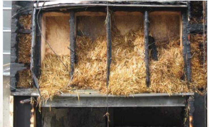
4 Le test de résistance au feu réalisé par le CSTB : les ballots de paille toujours en place dans les montants latéraux de la façade sont uniquement carbonisés en surface à certains endroits. Pour vérifier l'état intérieur des ballots, le CSTB a dû les sectionner. D'autres photos montrent les ballots en place et faiblement carbonisés en surface ; elles sont disponibles sur www.lemoniteur.fr/media/FICHER/2010/02/22/FICHER_2010_02_22_1059781.pdf
