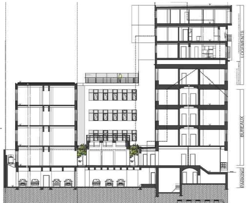
ventilation naturelle permet de se passer de climatisation active et l'ensemble des bureaux atteint le niveau très basse énergie avec 26,8 kWh/m<sup>2</sup>an.
